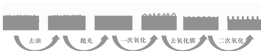
图 1 制备 AAO 膜的主要工艺流程图
