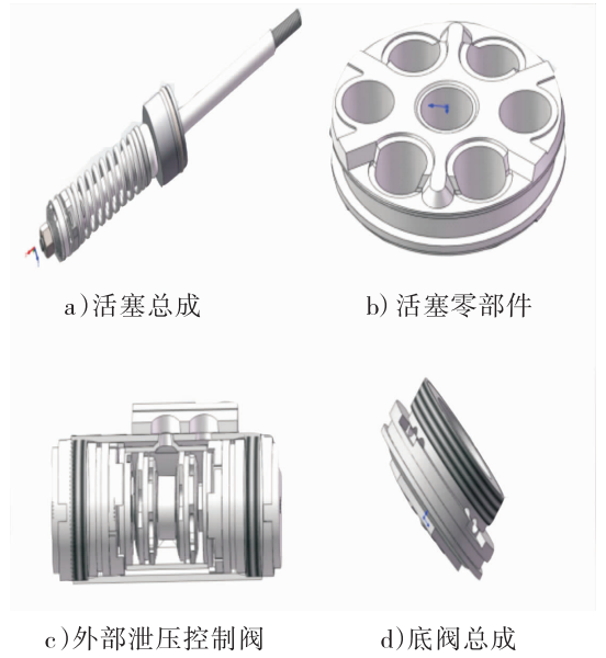
图2 阻尼四级可调减振器部件仿真模型
