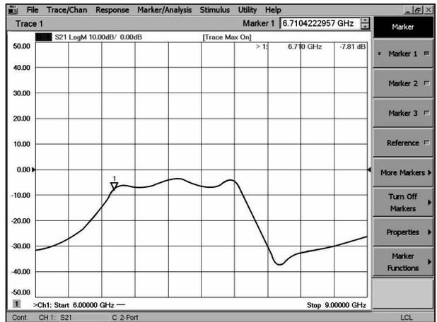
图7 带通滤波器 S21 参数实测结果
