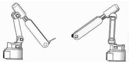
图 1 双机器人协作系统的结构模型 Fig. 1 Structure model of double-robot collaborative system
