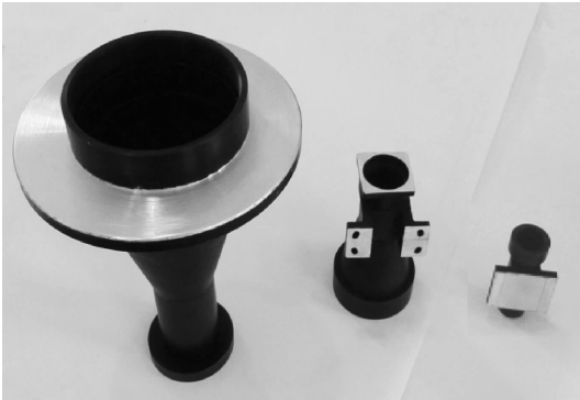
图3 光学镜筒局部着黑色处理效果图
