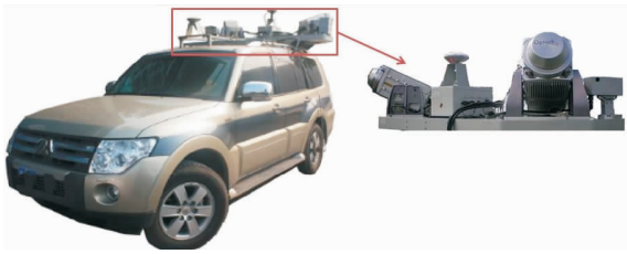
图1 Lynx V100 车载激光雷达系统
