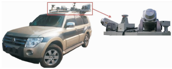
图 1 Lynx V100 车载激光雷达系统
