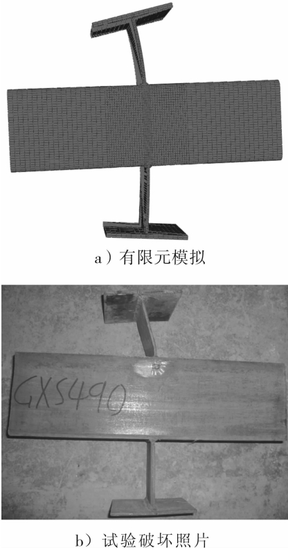
图 4 节点的破坏模式
